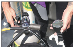
有些整合電腦錶是將感測器 / 發射器裝在調節器上，感測器讀出壓力後，會將訊號傳送到潛水員手腕上的電腦錶，因而無須管線。
