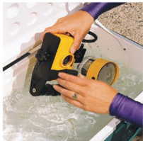
使用過後，要將你的相機徹底的浸泡在清水中。
