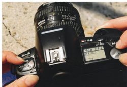
自動控制曝光的相機在操作上各有不同，但基本上你應設定底片 ISO 值和快門速度或將光圈值轉到 A “自動模式” 或 P “程式自動”。
