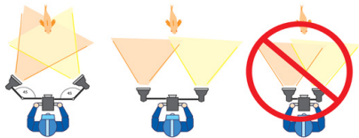
避免散射和熱點的作法是，你將燈光架設在這離一邊的位置。
